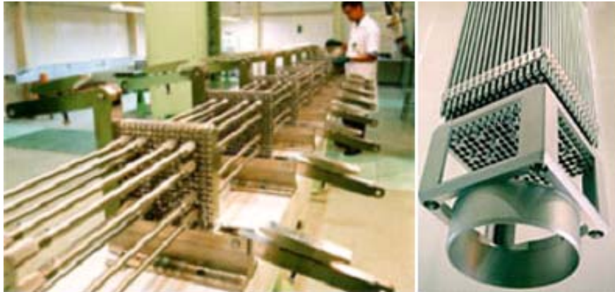
Figura 3: Montagem de um elemento combustível
