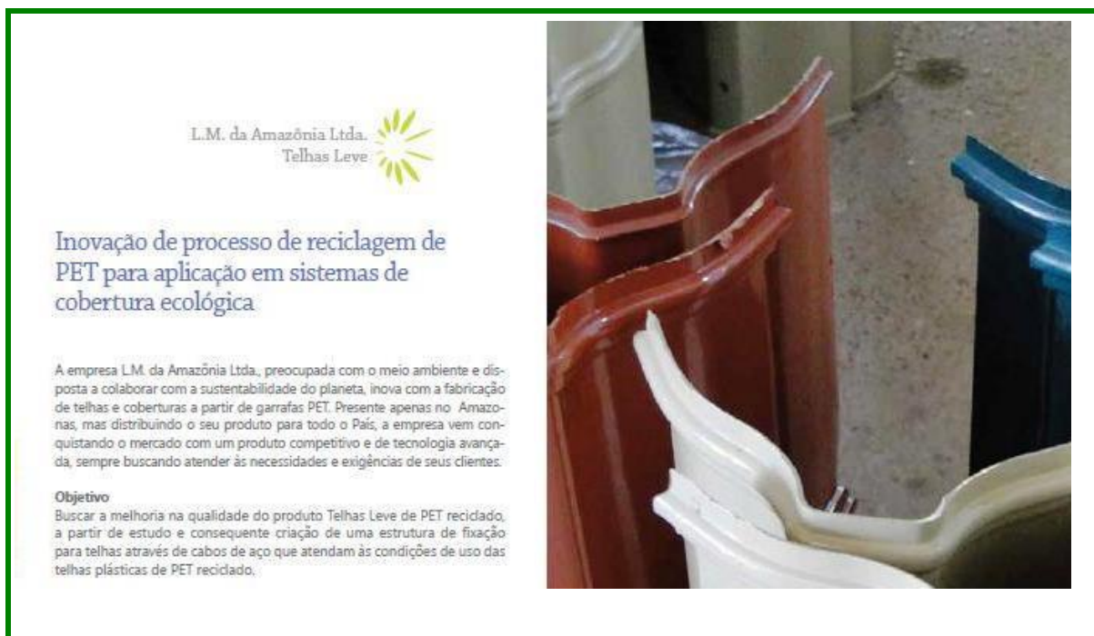
Figura 16 – Fabricação de telhas de garrafas PET para uso na construção civil
