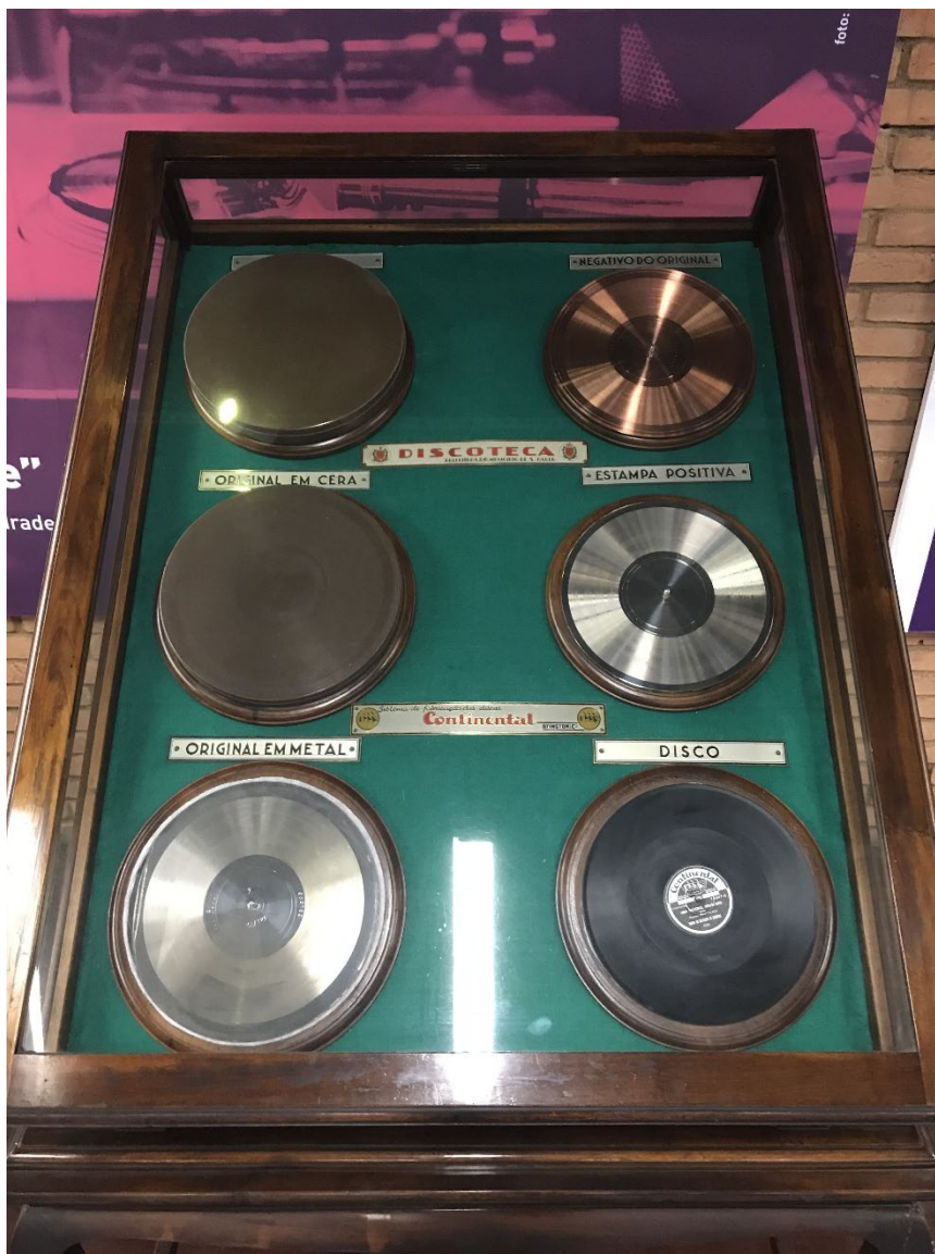
Figura 20 – Mostruário do sistema de fabricação de discos elétricos da Continental, incluindo o “original em metal” ou matriz fonográfica
